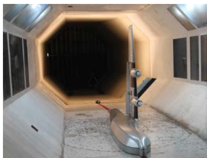
图 7 试验模型在风洞中的安装方式
